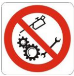
Esempio Vietato riparare e/ lubrificare organi in moto
